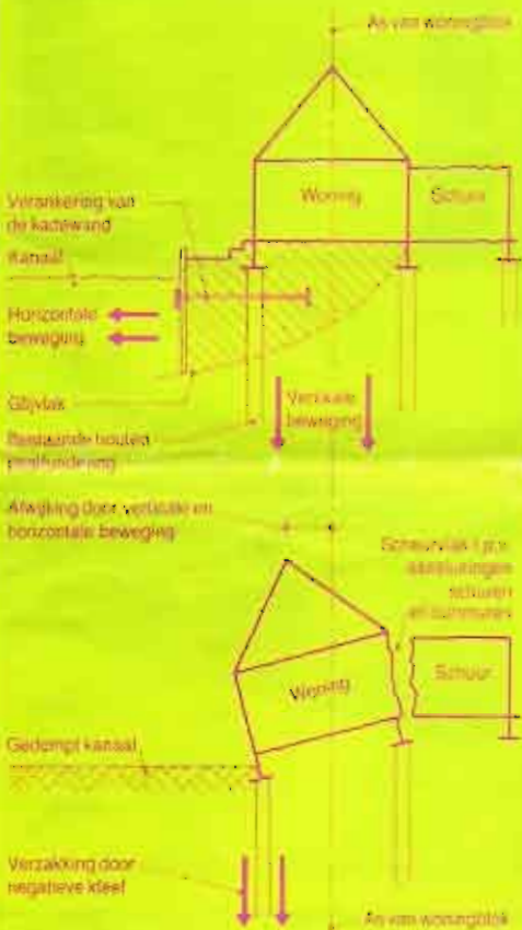
Principeschets van de verzakking
